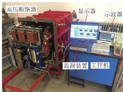
图 6 故障模拟及数据采集试验现场
