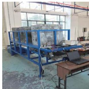
图 7 超声波水耦合煤岩界面识别实验系统
