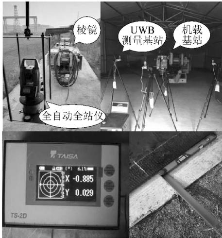
图9 掘进机位姿测量试验现场
