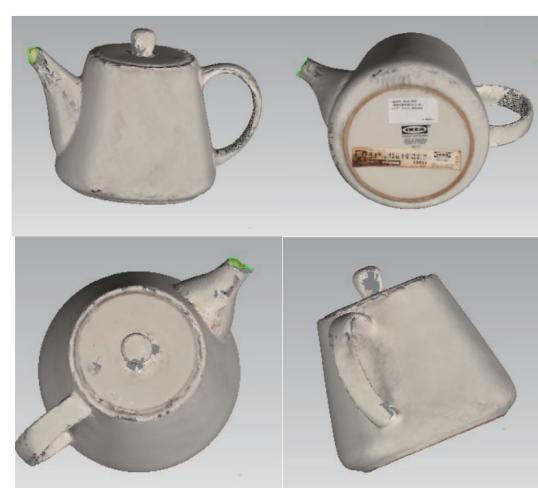
图 7 去除噪声点后模型的纹理映射结果
