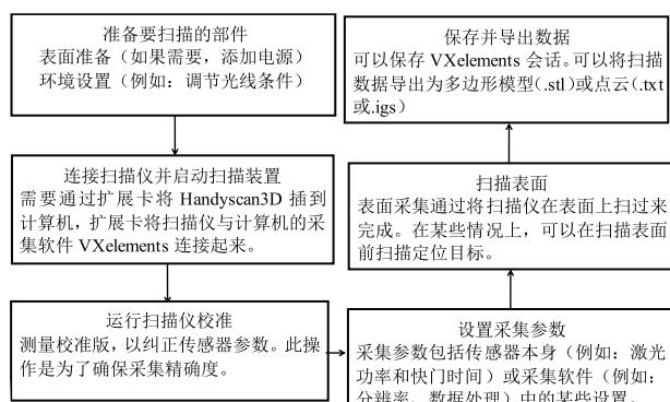
图3 Creaform3D扫描系统工作流程
