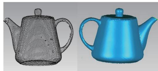
图 6 去噪后的点云及重建的三维模型结果
