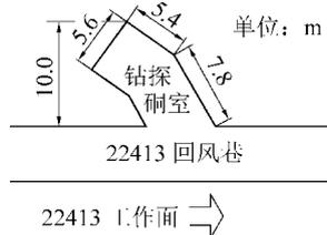
图5 22413回风巷钻探硐室施工
