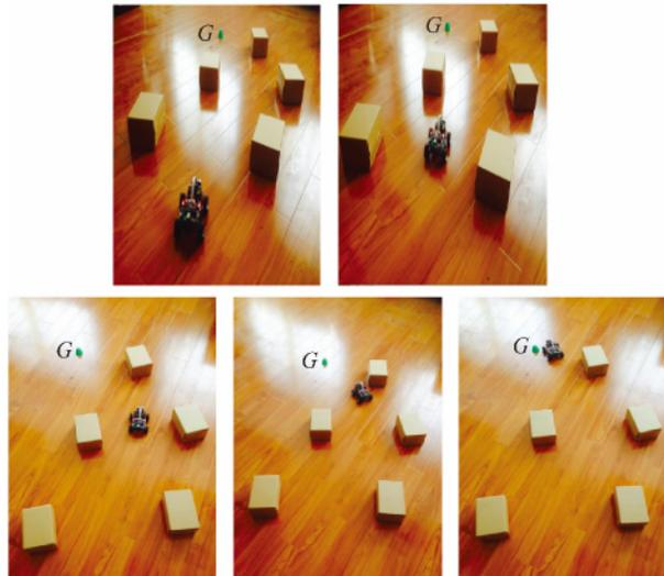
图 19 避障小车路劲规划实验
