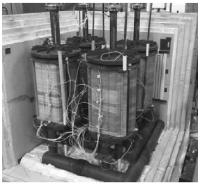
图 5 GEFC 50 kW 的 SOFC 模块 Fig. 5 GEFC 50 kW SOFC module
